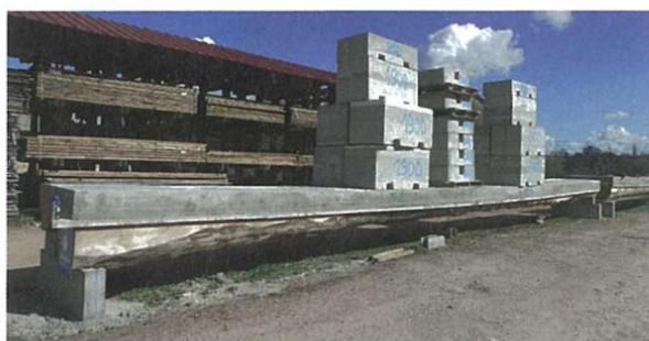
Des essais à la rupture et de fluage ont également été effectués sur deux «petits» prototypes de 15 mètres de portée pour une largeur d'1,5 mètre. Archipente Architectes
