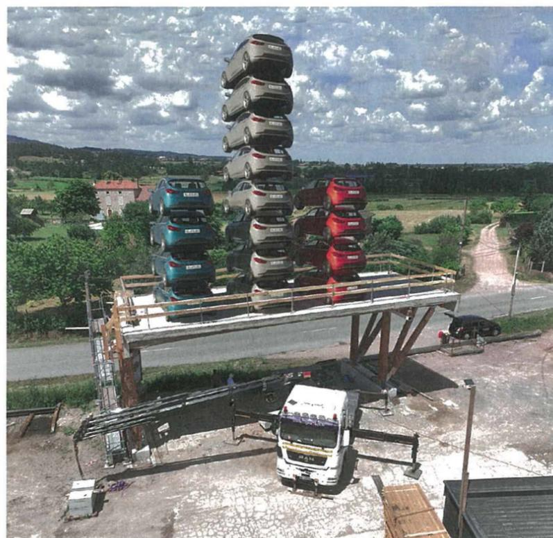
« Sous la charge de 24 tonnes représentant la charge de service du tablier, la flèche n'est que de 8 millimètres alors que la norme NF EN 1995-2:2005 accepte 32mm », indique Dominique Molard. La charge testée représente l'équivalent de 16 véhicules d'1,5 tonne ! Archipente Architectes
