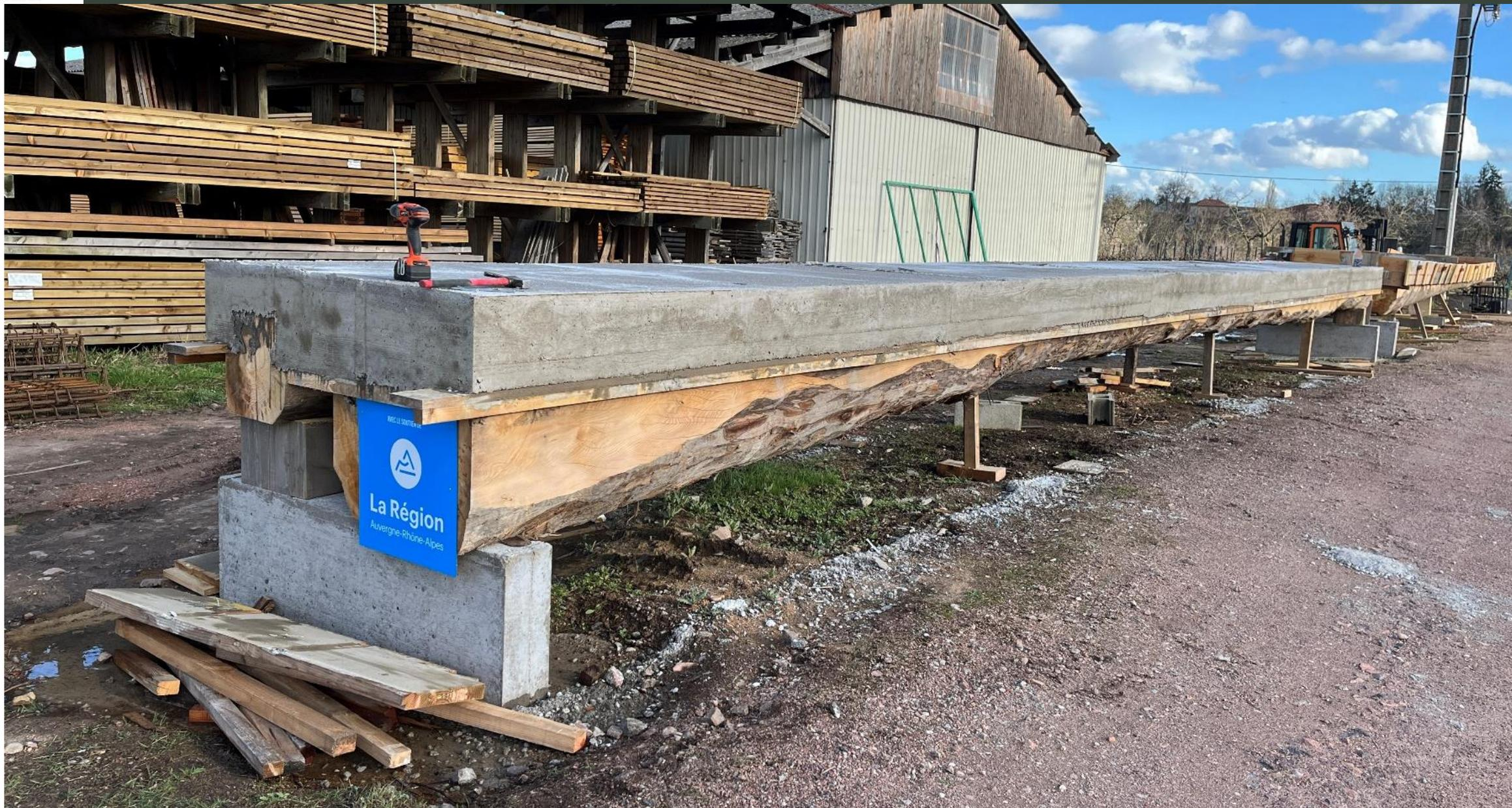
Petit Prototype pour essais: décoffrage avec maintien des étais jusqu'au 6 Avril 2023
