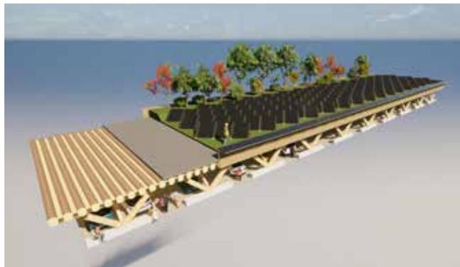
駐車場に設置された太陽光発電のための遮蔽屋根。高木による植栽が施され、防水処理された駐車スペースを自然に戻すことで、雨水の排水による河川への影響を避けることができます。
