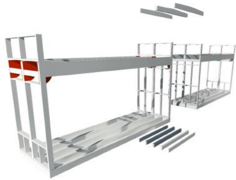
+ 1 - ATELIER: POSE STRUCTURE BOIS BEQ+BLC
