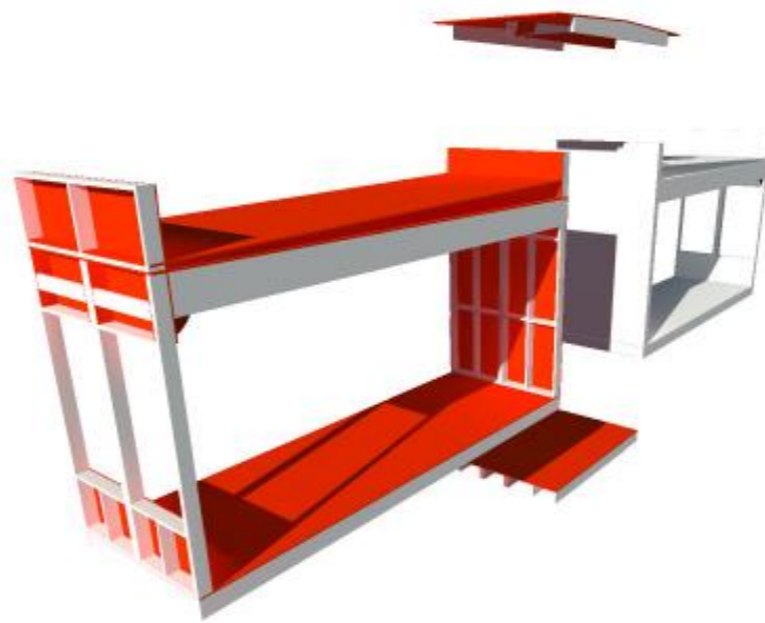
+ 2 - ATELIER: POSE PANNEAUX OSB
