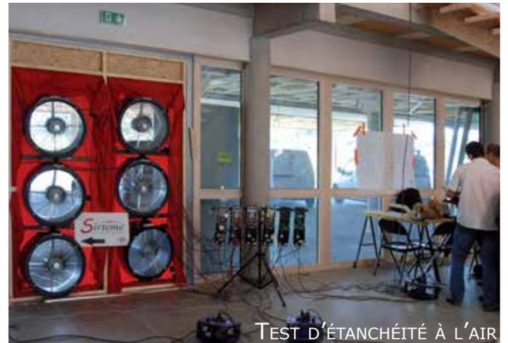
TEST D'ÉTANCHÉITÉ À L'AIR
